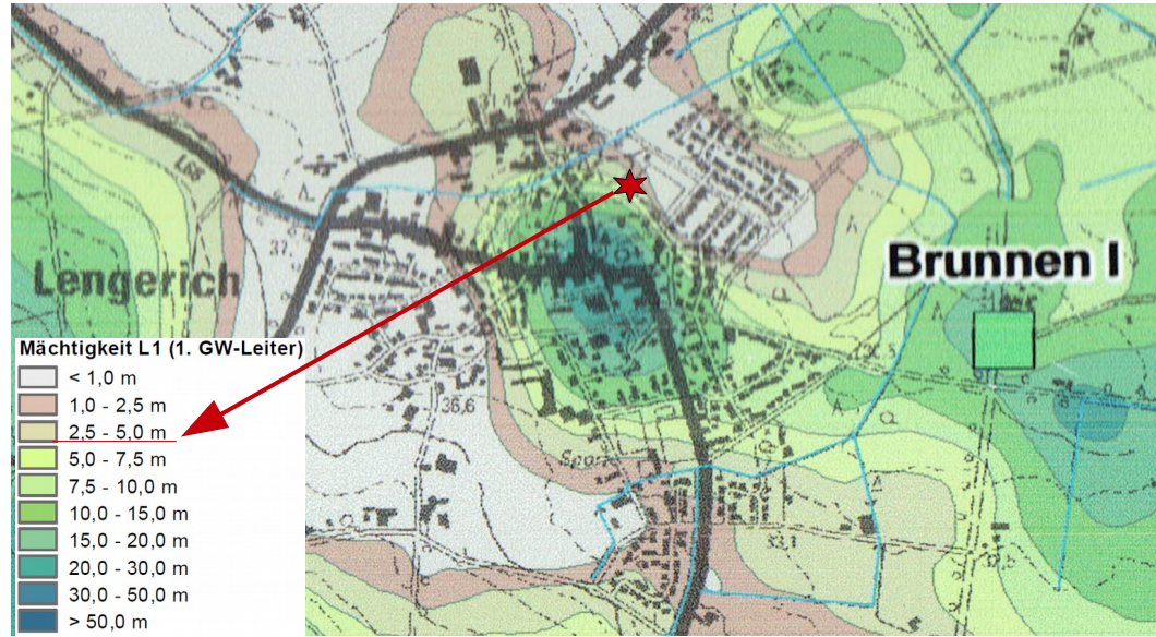
Auszug aus Pumpversuchsantrag: CAH-Anlage_4_2_Mächtigkeit_GWL1
